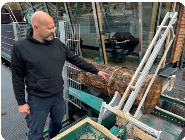
Bild links: Stefan Müller-Gei steht an der Kappsäge, die einen Anschnitt des Stammholzes macht. Dabei wird ein Bild erzeugt, das auf einen Bildschirm übertragen wird (Bild rechts). Muss die Qualität des Holzes aktuell noch per Augenschein vorgenommen werden, könnte dies künftig die Künstliche Intelligenz übernehmen. (Fotos: Alexander Löffler, LRA Kronach)
