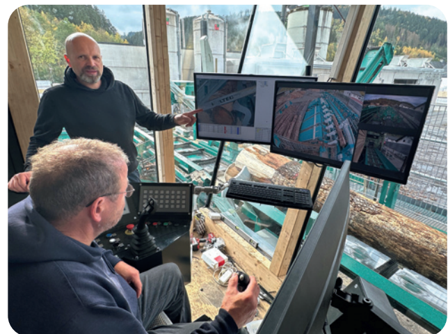
Bild links: Stefan Müller-Gei steht an der Kappsäge, die einen Anschnitt des Stammholzes macht. Dabei wird ein Bild erzeugt, das auf einen Bildschirm übertragen wird (Bild rechts). Muss die Qualität des Holzes aktuell noch per Augenschein vorgenommen werden, könnte dies künftig die Künstliche Intelligenz übernehmen. (Fotos: Alexander Löffler, LRA Kronach)
